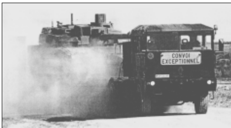
Рис. 1. Тягач «Рено» TRM 700-100 (6 x 6) с полуприцепом LOHR SR-PB60 для перевозки танков
