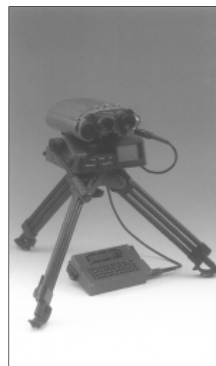
Рис. 5. Лазерный дальномер MAC 8450, входящий в комплект СУО
