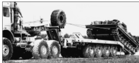
Рис. 2. Погрузка поврежденного танка на транспортер-тягач с помощью лебедки
